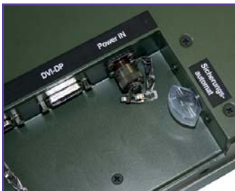
RD22 mit Sicherungsautomat
