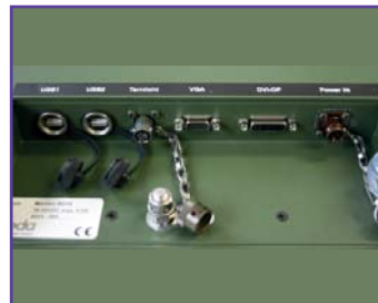
RD22 Beispiel für Standard Schnittstellen
