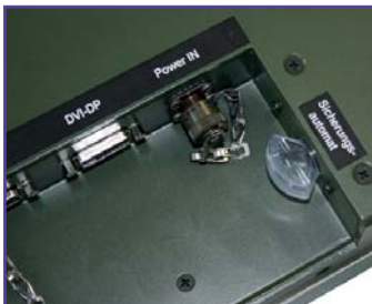
RD24 mit Sicherungsautomat
