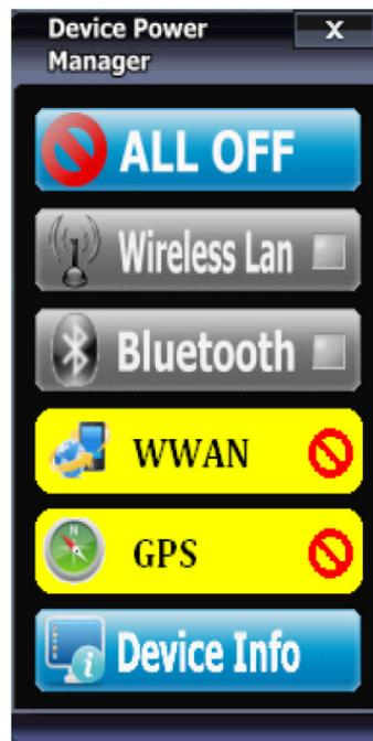
Abbildung 58: Device Power Manager WWAN und GPS im BIOS deaktiviert
