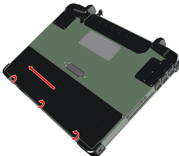
Abbildung 17: Akku Schrauben lösen
