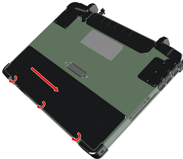
Abbildung 14: Akku Schrauben anziehen
