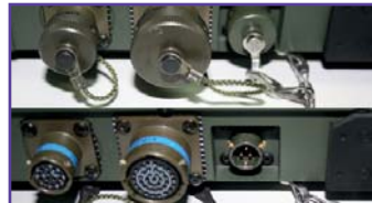
Rocky® RF10 Rückseite Beispiel für MIL Schnittstellen
