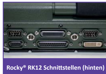
Rocky® RK12 Rückseite Beispiel für MIL Schnittstellen
